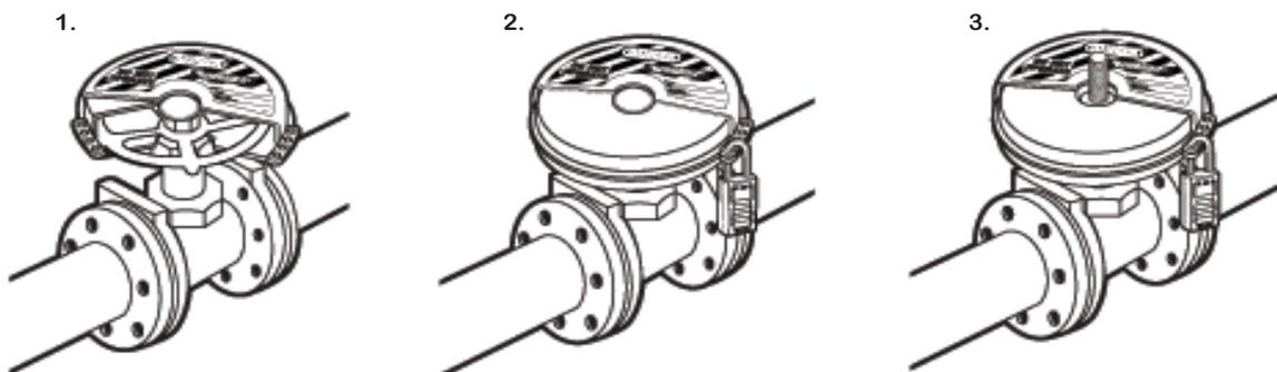
480 s'adapte à des vannes de diamètre de 15 à 76mm
